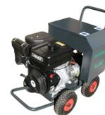
**Idropulitrice SCi 300 + Serbatoio sabbia + Lancia Sabbiante + Sonda Esterna = Idrosabbiatrice SCS 300**
